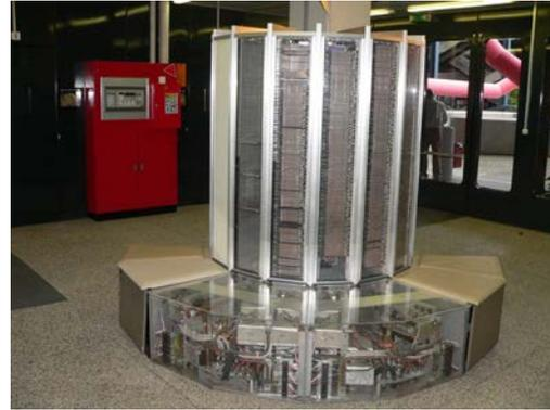
SUPERCOMPUTADORA CRAY-1, CON FORMA CURVEADA
