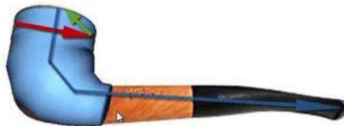
Figura 4.42. Extracción de un modelo de la realidad mediante el software 3- Sweep ( www.3ders.org )
