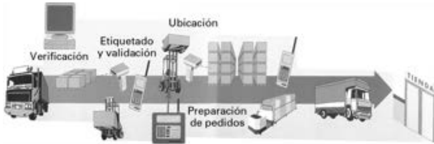
Figura 1.48. Esquema gráfico de radiofrecuencia
