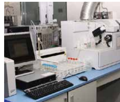
Los componentes de la muestra se ionizan por efecto de un plasma de argón. Los iones producidos serán separados en base a su relación masa/carga en un espectrómetro de masas y posteriormente cuantificados por un detector multiplicador de electrones. Empleado en la determinación de residuos de plomo, bario y antimonio en casos de disparo con arma de fuego.
