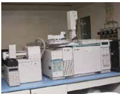
La cromatografía de gases con accesorio de headspace y detector de ionización de flama es una técnica empleada para la cuantificación de compuestos volátiles, principalmente alcohol etílico en sangre y orina.
