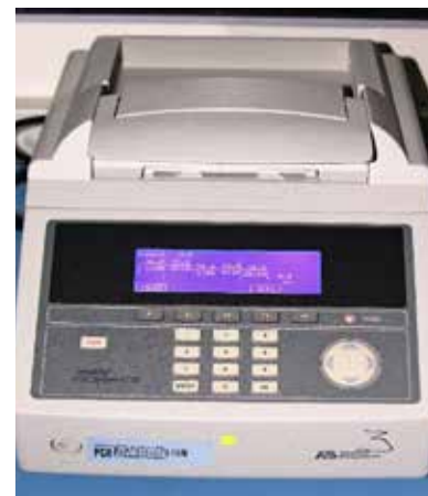
Termociclador 9700, equipo que lleva a cabo la reacción en cadena de la polimerasa (PCR) a través de ciclos de temperaturas puede multiplicar las diversas regiones de uso forense y marcándolos con fluorocromos para poder ser analizados en los secuenciadores de ADN.
