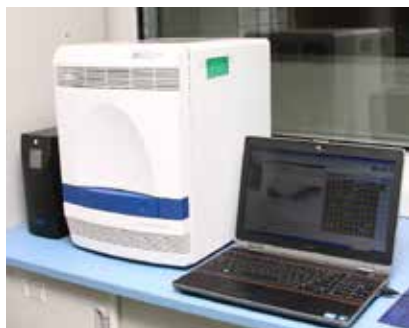
Termociclador de punto final. A través de ciclos de temperatura, realiza el copiado y el marcaje fluorescente de las regiones de ADN humano que nos interesa caracterizar.
